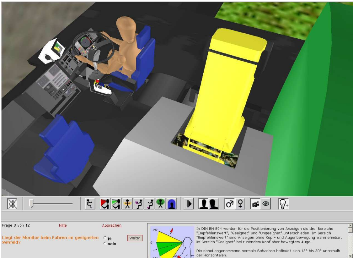
Abbildung 15.3: Szenario „Abfallsammelfahrzeug“ zur Fahrzeuggestaltung mit aktuell bearbeitetem Gestaltungskriterium
